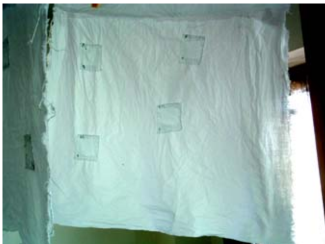
試験片を縫い付けた試験布の風乾
