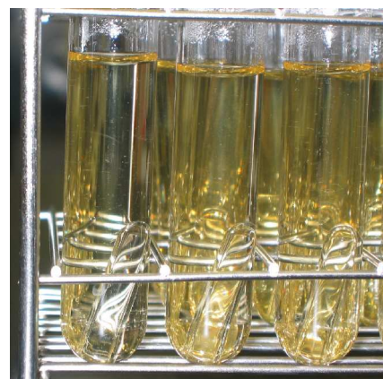
拡大図 気泡は発生していない。
