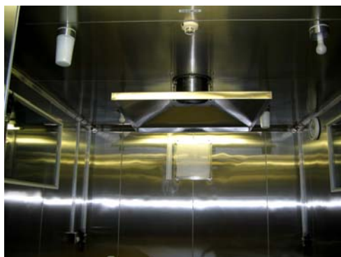
図3 恒温恒湿室内のモデルハウスの内部と屋外用白熱電球用照明器具
