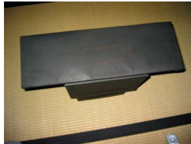
図 6 測定のため照度計を置く台
