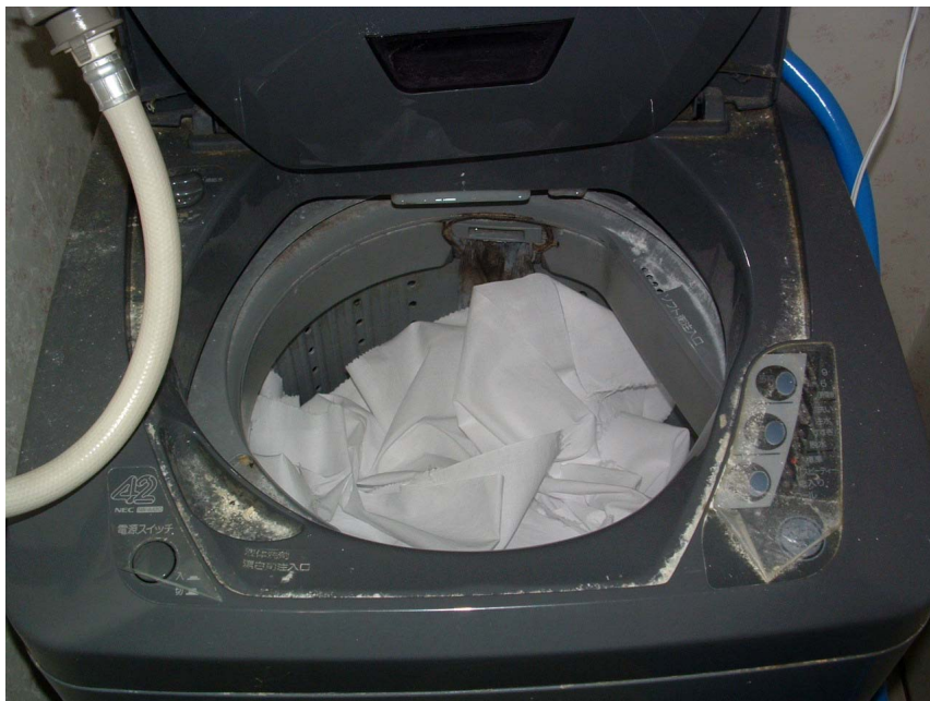
洗濯機 C へ試験布及び調整布を入れたところ
